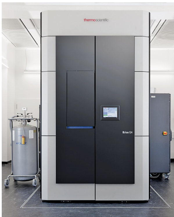
Abb. 1 Das Kryo-Elektronenmikroskop Titan Krios G4 ist etwa 3 m hoch. Im Inneren wird die Probe in einer Kryo-Box durch Flüssigstickstoff gekühlt und vor Kontamination geschützt. Zudem ist es gegen mechanische und elektromagnetische Störungen aufwendig isoliert. Eingesetzt wird es für biologische Strukturuntersuchungen am Ernst-Ruska-Centrum im Forschungszentrum Jülich (Foto: R.-U. Limbach, FZ Jülich).
